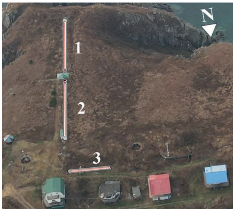
Рис. 1. Схема расположения лазерных деформографов:
