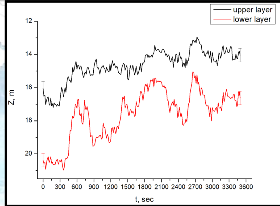
Временная зависимость положения зарегистрированных границ промежуточного слоя (период возмущений – 3-4 мин амплитуда – около 3 м)
