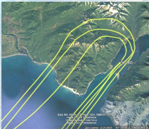
Пространственное положение галсов при выполнении лидарной батиметрической съемки
