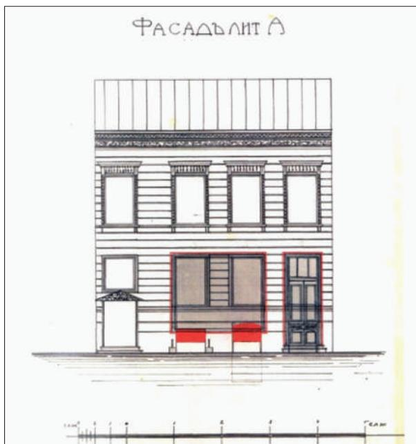
Рисунок 15 — «Фасад лит. А» (д. № 30–31). Фиксационный чертеж с обозначением мест предполагаемой частичной перестройки. 26.05.1917 г.
